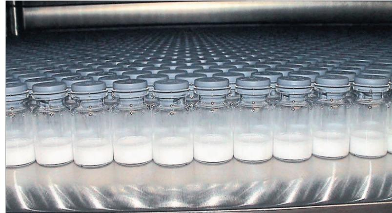
In sogenannten Vials werden zum Beispiel Impfstoffe gefriergetrocknet und somit haltbar gemacht.
